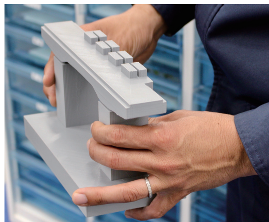
TREND-COREデータから3Dプリントした橋脚の模型
