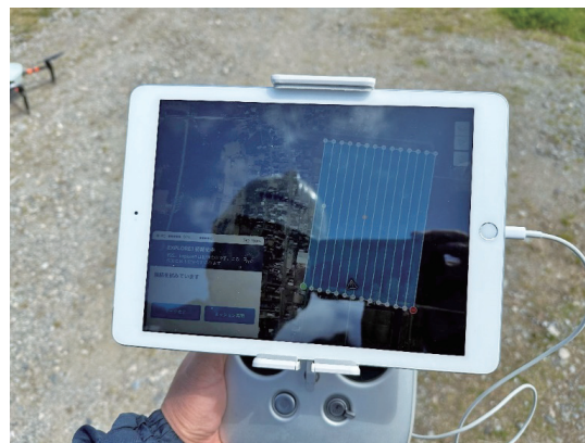
写真-6 エリアを設定し、ドローンが自動航行
