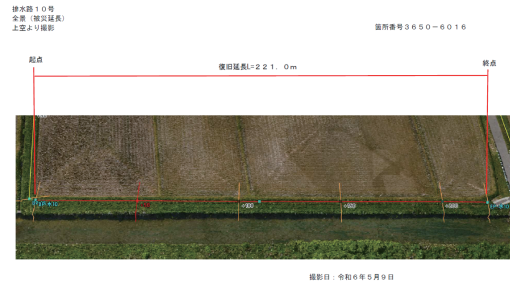
図-1 ポール、リボンテープを省略し、写真に起終点、延長を記載
