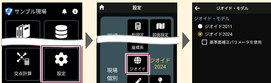
一部の離島地域での衛星測位で、離島独自の平均海面からの高さを標高とする場合は、[基準面補正パラメータを使用] チェックボックスをオンにしてください。
