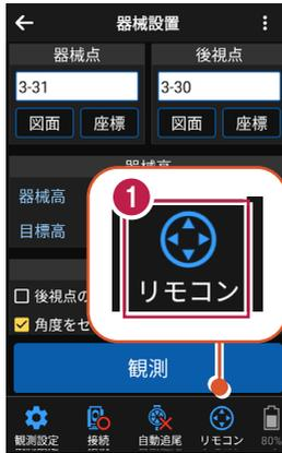
2 リモコンで器械をプリズムの方向に向けてから [サーチ] をタップします。
