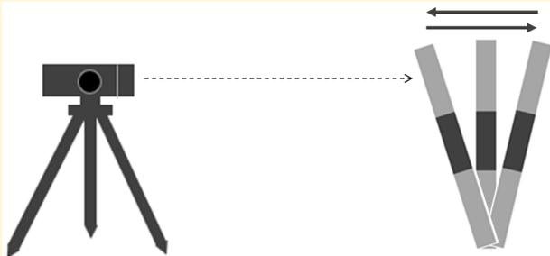
ウェービング観測に対応しているメーカーに設定している場合は【観測】ボタンの横に【W】チェックマークが表示されます。
