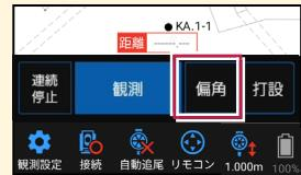
**器械が「手動」の場合は、設置位置までの「水平角」と「水平距離」を確認できます**
