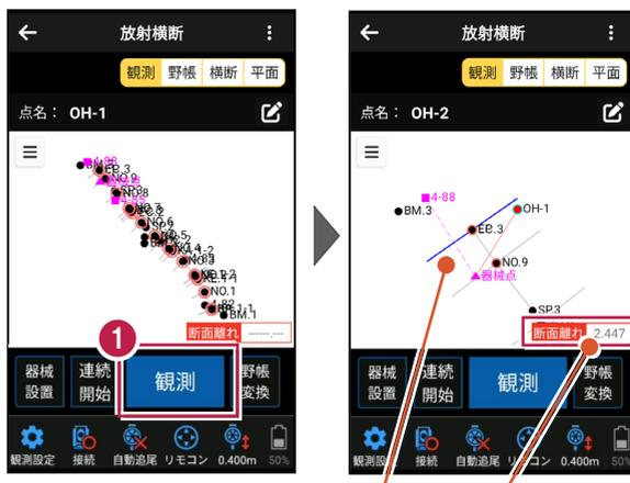
断面からの離れが表示されます。対象線形の全横断に対して一番近い値を表示します。断面離れの対象になった横断線はハイライト表示します。
