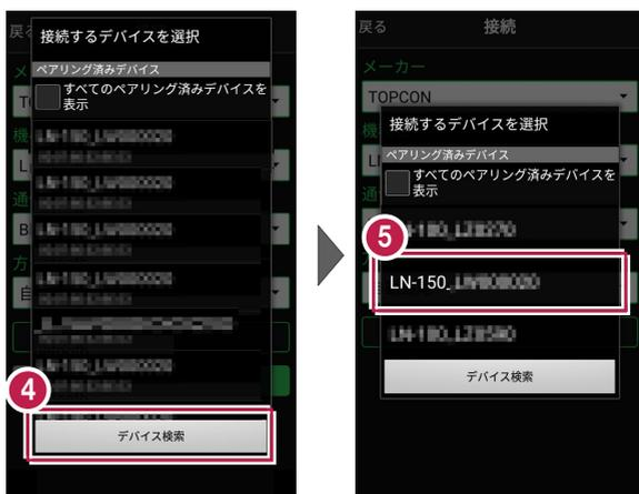
6 器械と接続されると、器械の設定画面が表示されます。各項目をタップして、設定を確認してください。
