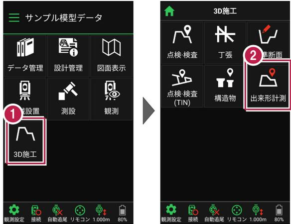
3 [線形] で、出来形計測で使用する線形を選択します。
