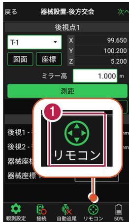
2 リモコンで器械をプリズムの方向に向けてから [サーチ] をタップします。
