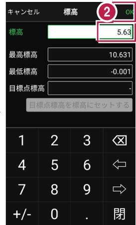
2 計測点の [標高] を入力して、[OK] をタップします。
