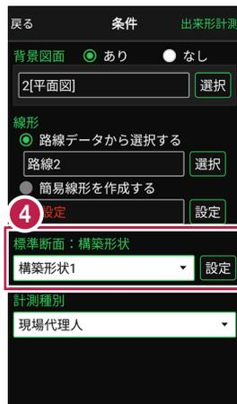
5 [標準断面：構築形状] の [設定] をタップします。
