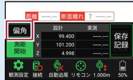
器械が「手動」の場合は、計測点までの「水平角」と「水平距離」を確認できます
