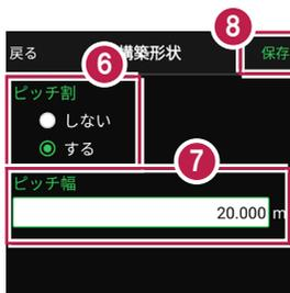
7 [ピッチ幅] に、計測する横断面のピッチ幅を入力します。
