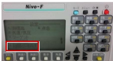
10 [データ出力先] を「通信ポート」に設定して [ENT] を押します。
