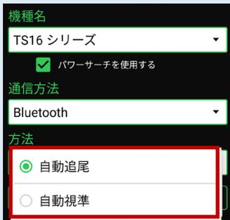
観測方法が「自動追尾」で、測距時にプリズムを捕捉していない場合は、通常のサーチではなくパワーサーチが動作します。
