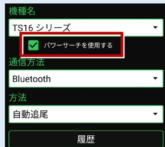
観測方法が「自動追尾」で、測距時にプリズムを捕捉していない場合は、通常のサーチではなくパワーサーチが動作します。
