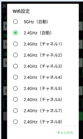
※ Wi-Fiの周波数帯（5GHz ⇄ 2.4GHz）を変更した場合は、TSの電源を切ってTSを再起動してください。
