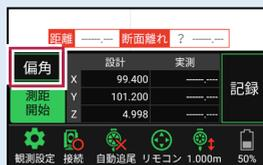
器械が「手動」の場合は、設置位置までの「水平角」と「水平距離」を確認できます
