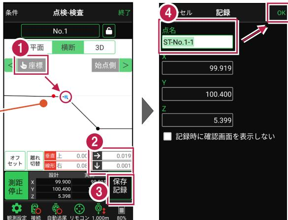
※ プリズム（ミラー）の移動距離や目標点までの距離により、画面の更新頻度は適切に制御されます。
