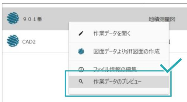
また、データの上で右クリックをすると、TREND-ONE の作業データのプレビューを表示することができます。TREND-ONE を起動しなくてもその場で作業データのプレビューが行えるので、作業の効率化が図れます。
